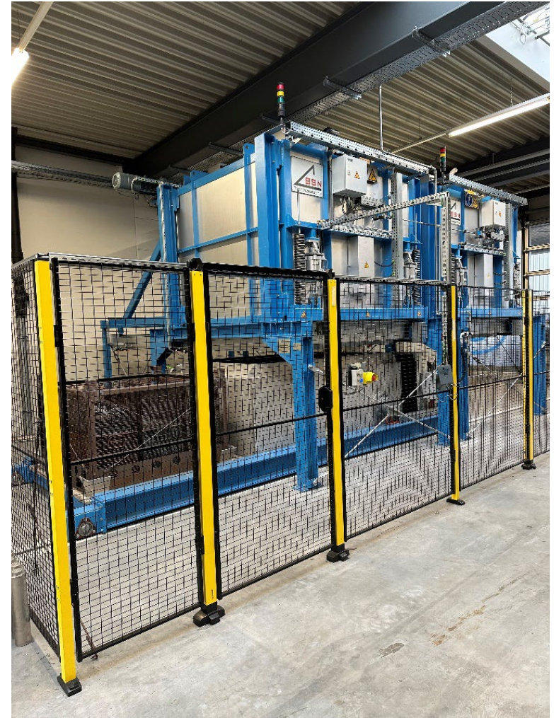
Abbildung: Chargierung mit 12 Körben
